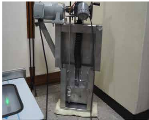
[ 침수자동 배수장치 시제품 ]
