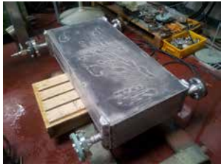
1/3 x 1/3 x 1/3 scale 열교환기 설계 및 제작 완료
