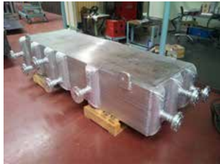
1/2 x 1/2 x 1/2 scale 열교환기 설계 및 제작 완료
