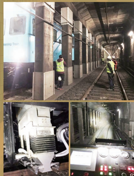
그림 13 | 테스트베드 구간 미세먼지 효율 공인시험 모습
