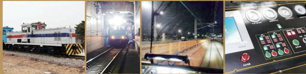
그림 7 | 개발차량 기본시험(구원연결, 구배등판, 주행시험)
