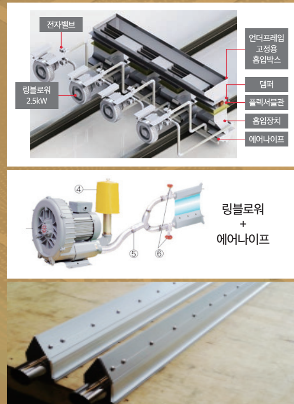
그림 9 | 차량 하부 흡진 시스템 구조
