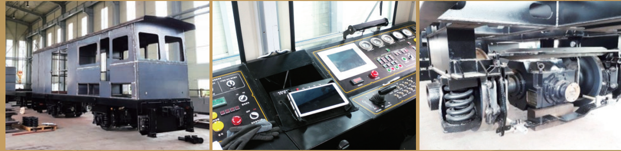
그림 6 | 차량 프레임, 운전석, 하부 모터 장치 제작
