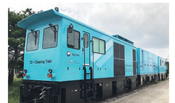
그림 15 | 최종 개발된 초미세먼지 제거차량 모습
