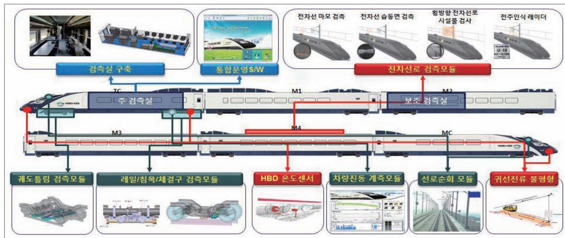
고속검측시스템 개발현황 개요도
