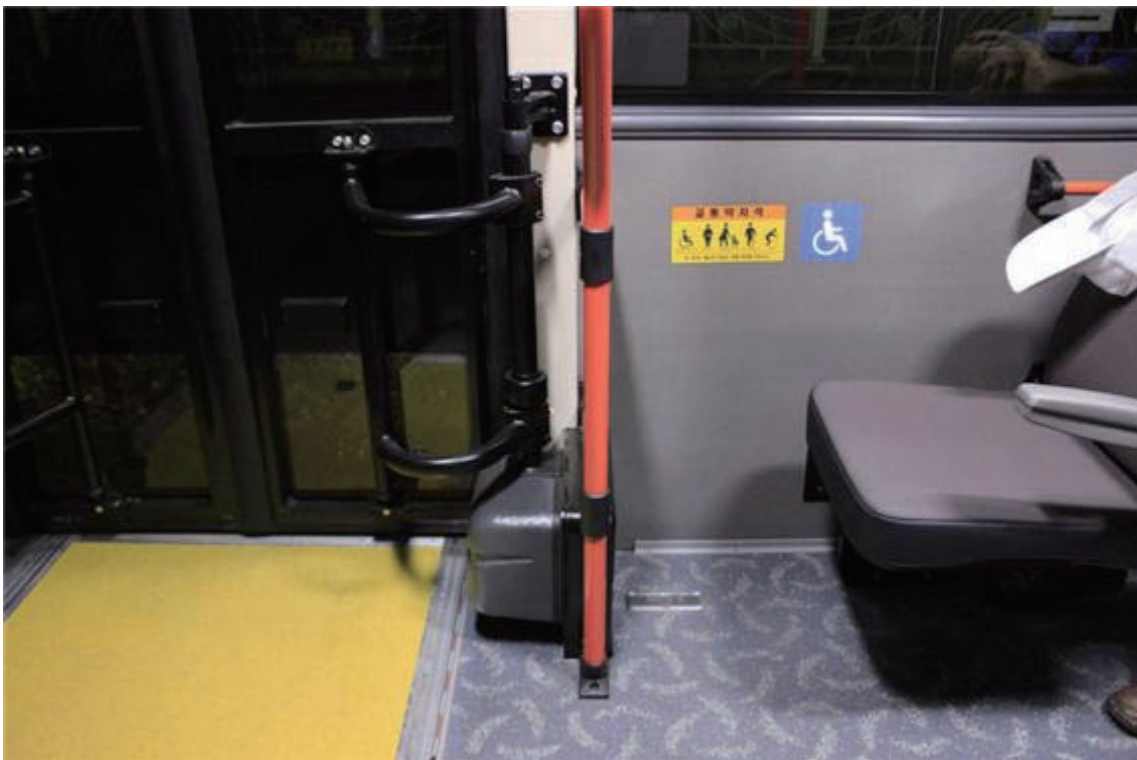
중형저상버스 표준모델은 탑승한 휠체어의 이동거리가 짧아 편리하다. 대형 저상버스에 비해서는 월등히 짧고, 해외 제조사의 2층 저상버스에 비해서도 역시 짧다.
