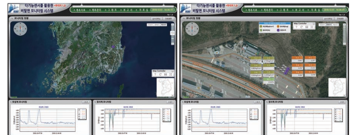
다기능센서를 활용한 비탈면 모니터링 시스템 (두더지 1.0)
