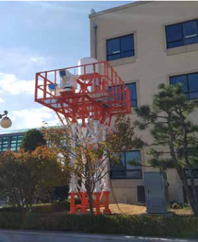
■ 고정형 이물질 자동탐지 시스템 (한서대학교 태안비행장)
