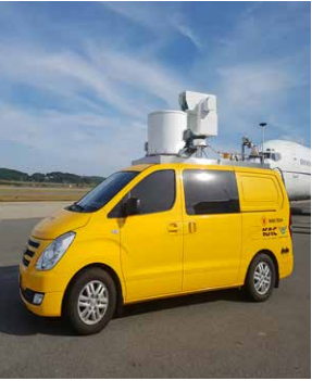
■ 이동형 이물질 자동탐지 시스템 (한서대학교 태안비행장)
