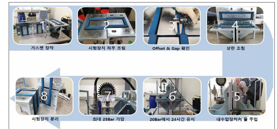
■ EPDM Gasket 내수압 시험 순서도
