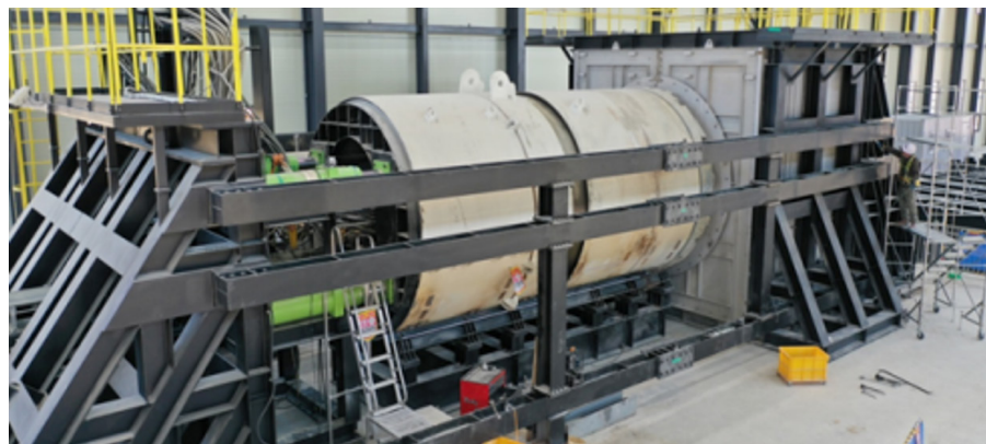
소단면 TBM 1) 선단부 굴진 시험 장비
