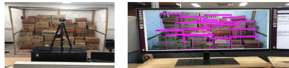
(a) 실험환경 (b) 실시간 화물인식 결과 [Faster R-CNN 이용한 화물인식]
