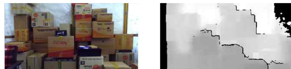
(a) RGB 이미지 (b) Depth 이미지 [스테레오 카메라를 이용한 화물인식]
