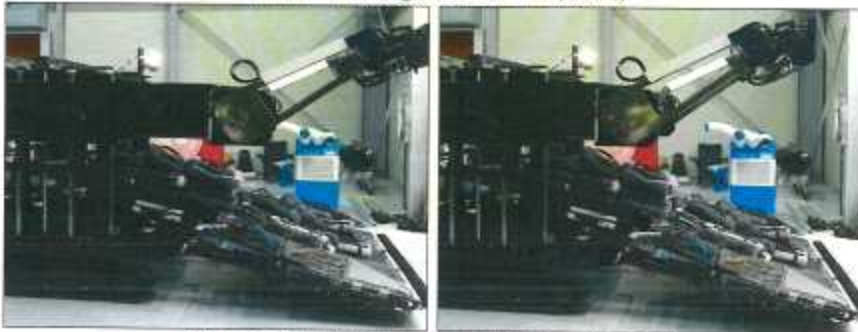
<적재 후 가변 컨베이어 전진 후진 작동 검사 전경>
