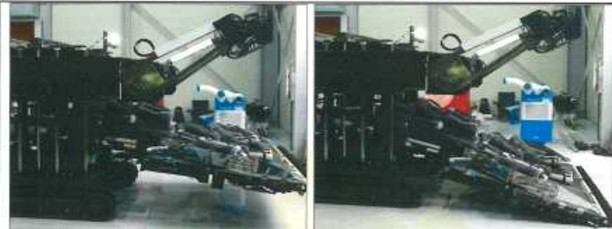
<적재 후 컨베이어 상 하 작동 검사 전경>
