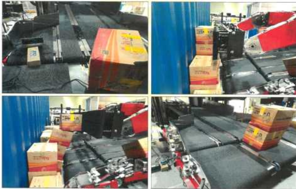
<사진7. 그립퍼 모듈 흡착능력 확인 전경 및 결과>
