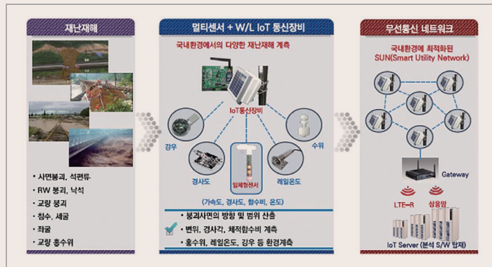
철도시설물 관리 IoT 계측시스템 현장 TESTBED 구축 구성도
