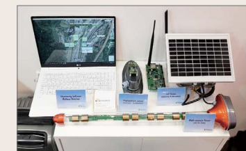
철도시설물 관리 IoT 계측시스템을 위해 제작한 시제품
