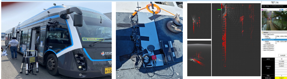
굴절차량용 위치트래킹기반 장애물 퓨전인지 시스템. 굴절각 추정기를 기반으로 카메라와 LiDAR의 위치와 각도를 보정하고 퓨전으로 주변 장애물의 실시간 인지 수행
