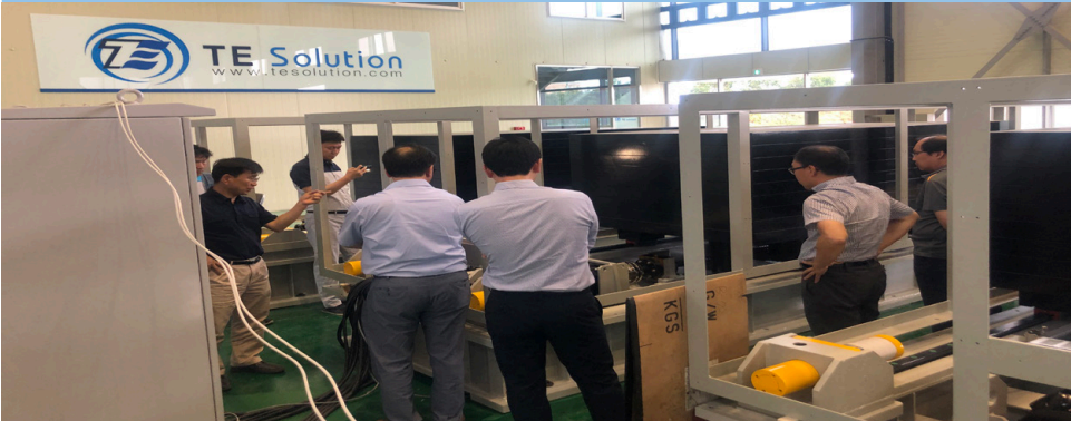
1915 차나칼레 대교(터키 랍세키) 주탑(335m)에 설치한 30ton AMD의 공장시험 검수전경
