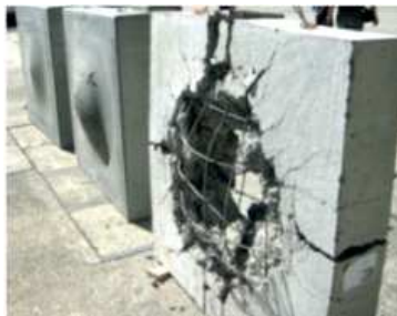
(a) 콘크리트 슬래브 폭발 실험 결과 (Gotz Vollmann, 2015)
