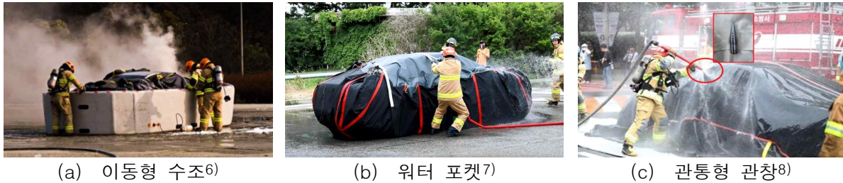
[그림 1-9] 현재 기술수준에서 전기 자동차 화재진압 방법
