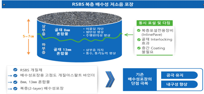
[그림 2] RSBS 복층 배수성저소음 포장 기술의 요약
