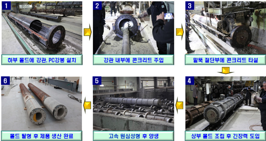
[그림 2] PCFT말뚝 제작 순서(트레미관을 이용한 콘크리트 투입방식)
