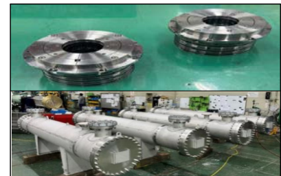
< 건식가스 밀봉장치(上) / 열교환기(下) >
