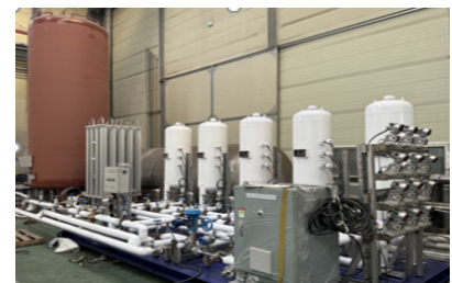
<극저온 냉열저장 장치 설계 및 시작품 제작>
