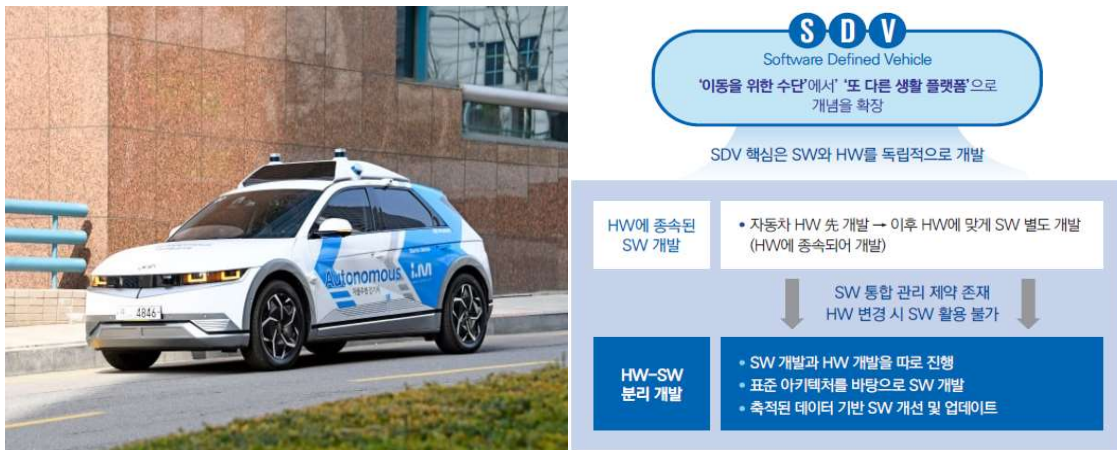
<그림 4-18> 현대 아이오닉5 로보택시와 현대자동차 그룹의 SDV 개발방식 자료 : 소프트웨어로 달리는 자동차, 완성차 업계가 꿈꾸는 미래, 삼성KPMG(`24.5월)
