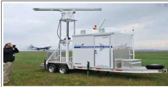
미국 로건공항 MERLIN Aircraft Birdstrike Avoidance Radars
